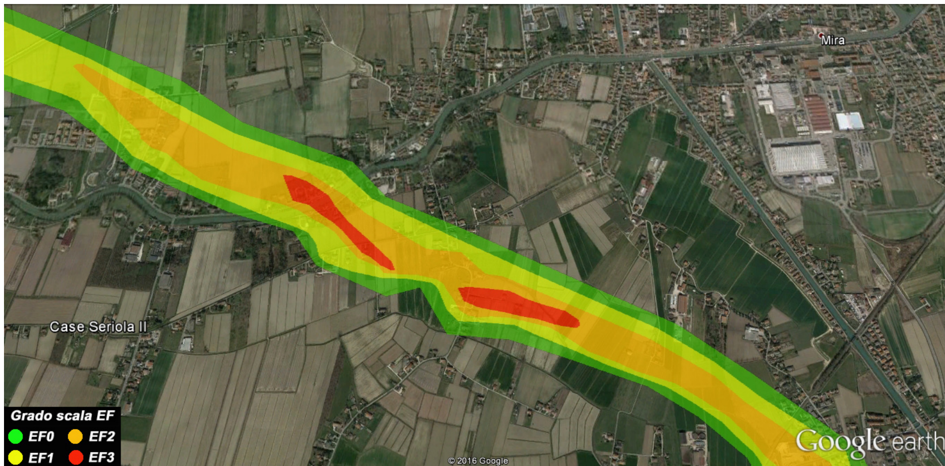
Isolinee di danno tra Dolo e Mira (Riviera del Brenta).
