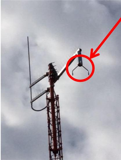
L'**anemometro** è di tipo ultrasonico e fornisce valori medi del vento a 2' e a 10' (in funzione dell'uso aeronautico del dato), aggiornati ogni 3". Il valore calcolato ogni 3" è la media di campionamenti al decimo di secondo.
