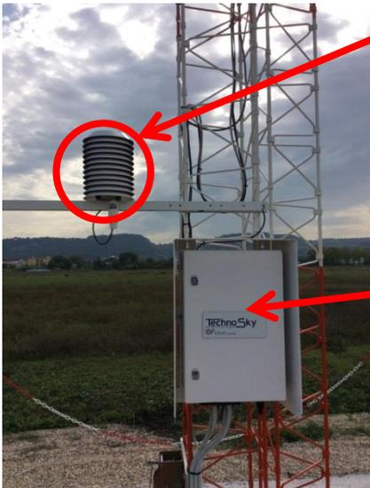
Il **termoigrometro** misura temperatura e umidità dell'aria, ricavandone quindi la temperatura di rugiada. Il sensore viene protetto dalle precipitazioni e dalla radiazione solare diretta con una schermatura "a piatti" (*shields*), che ne assicura la ventilazione.
