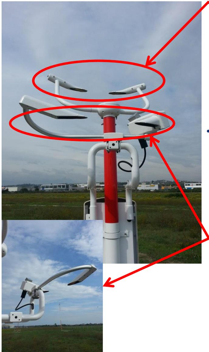
Il **visibilimetro** fornisce la visibilità attraverso una misura della riflessione a  $42^\circ$  (*forward scatter*) di luce IR emessa, da parte delle particelle sospese in aria. Il valore è relativo al punto di installazione dello strumento e può differire dalla visibilità stimata dall'osservatore umano, integrata sul giro d'orizzonte aeroportuale.
