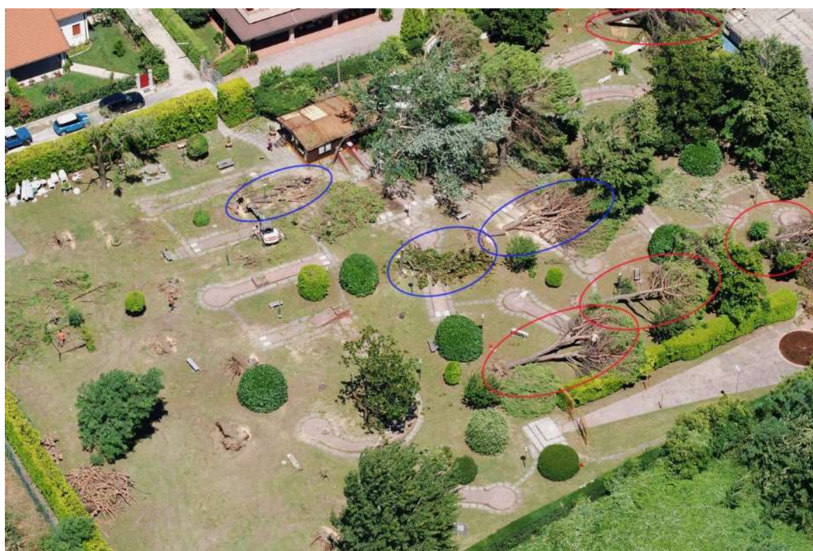
Fig. 5.28 – Danni al minigolf di Montegrotto Terme (PD). Le ellissi rosse e blu indicano gli alberi abbattuti nella medesima direzione (verso est), rispettivamente quelli non tagliati e quelli già tagliati, a seguito del downburst.
